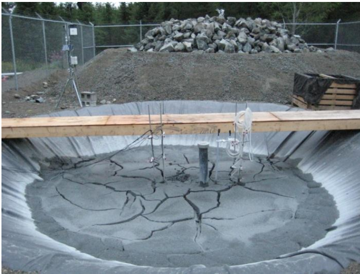
Figure 20-3 : Cellules expérimentales – Cellule des résidus en avant-plan, cellule de stérile (dunite serpentinisée) en arrière-plan. Le diamètre des cellules est de 5 m
